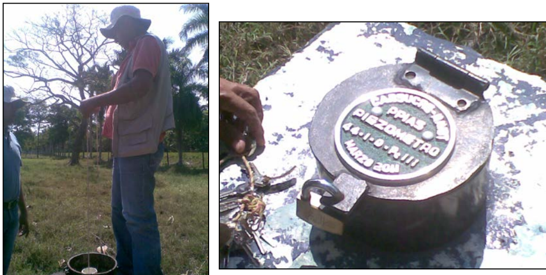
Figura 7.- Medición de niveles con sonda, piezómetro perteneciente a proyecto PPIAS de CARSUCRE (Elaboración propia)
