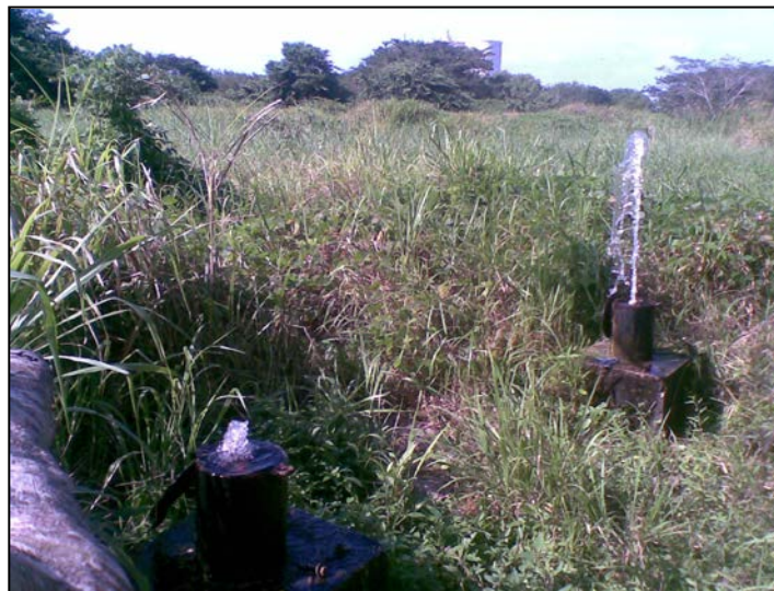
Figura 9.- Vista de Grupo de Piezómetros Saltantes. Sociedad Portuaria. Tolú. Elaboración propia
