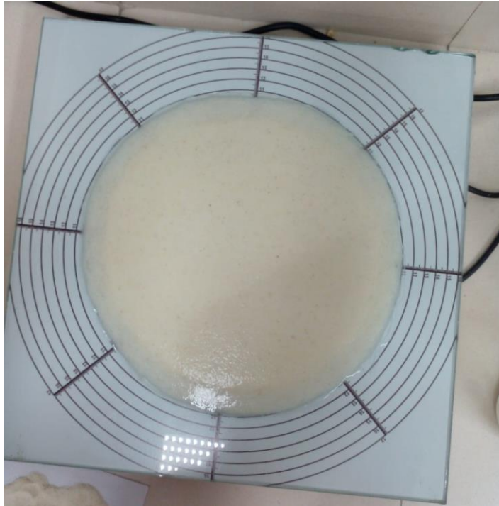
FIGURA N°14. EXPANSIÓN 10.5 SEPARACIÓN DE AGUA 0.4 EXPANSIÓN FUERA DEL PARAMETRO
