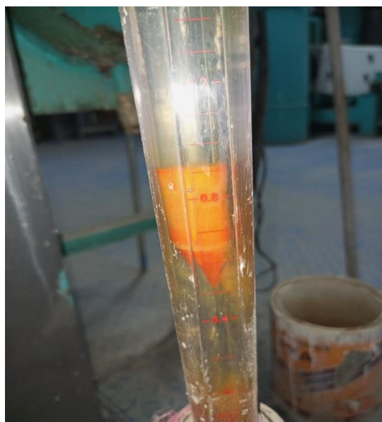
FIGURA N°13. ROTAMETRO DE ALIMENTACIÓN AGUA A COCINA 900L/H ENTRADA A LA COCINA
