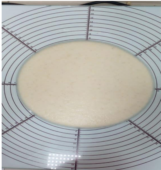
FIGURA N°14. EXPANSIÓN 10.5 SEPARACIÓN DE AGUA 0.4 EXPANSIÓN FUERA DEL PARAMETRO
