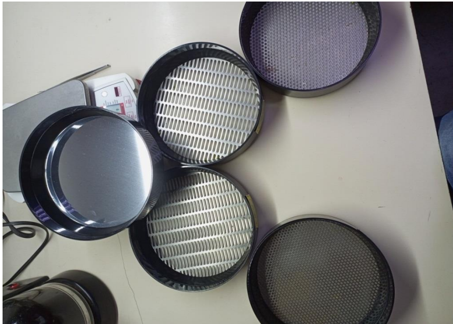
Figura 2: sarandas circulares de 4mm y 3mm, 2 sarandas oblongas de
