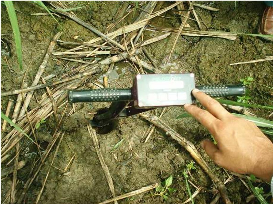
**Figura 15. Aspecto de la medición del contenido de humedad en el suelo con uso de sonda TDR a profundidad de 0-40 y 0-60cm.**
