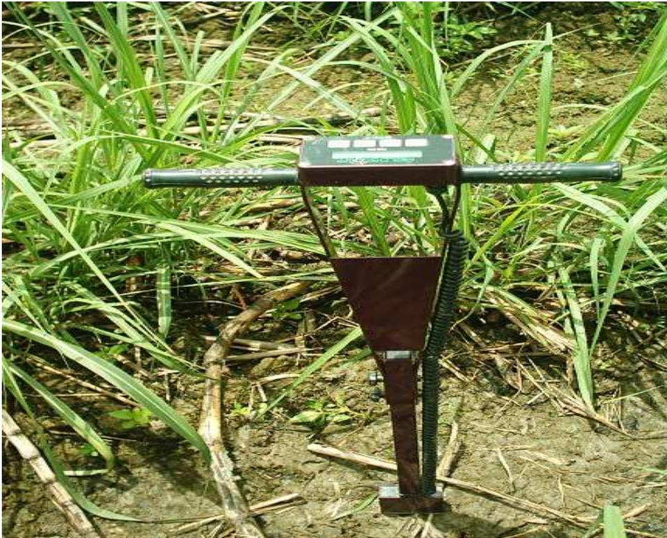
**Figura 9**Sonda TDR para determinación de contenido de humedad en suelo.
