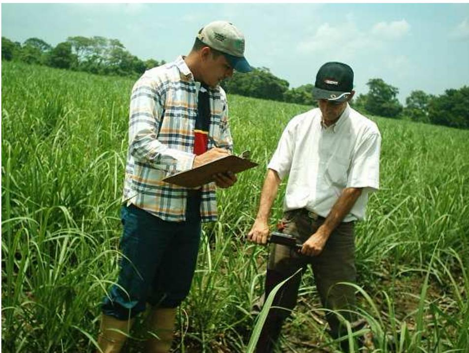
**Figura 14. Muestreo para determinación de contenido de humedad en el suelo con uso de sonda TDR, en etapa de crecimiento del cultivo.**
