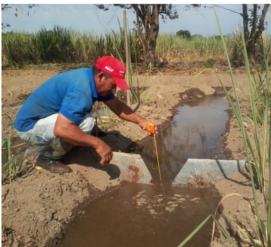
Medición de caudal en canal principal y en surcos
