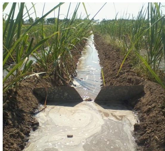
Medición de caudal en canal principal y en surcos
