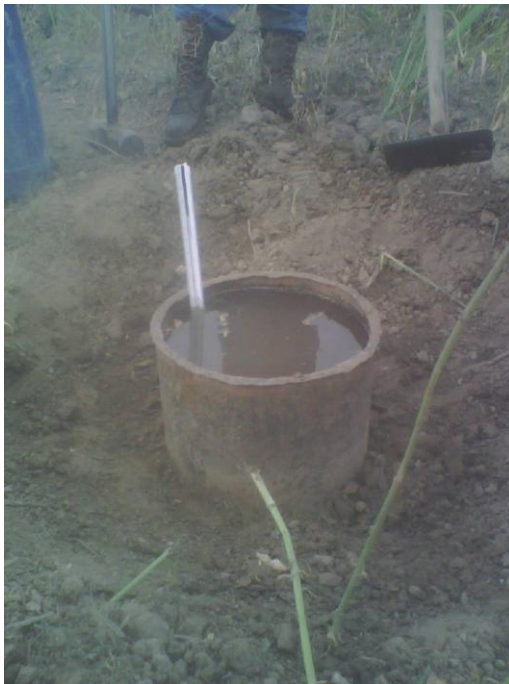
Proceso de medición de la infiltración con el cilindro Infiltrómetro
