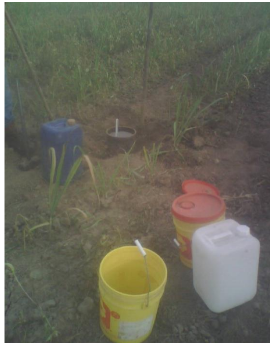
Proceso de medición de la infiltración con el cilindro Infiltrómetro
