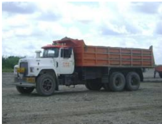
Figura 6. Camiones tipo volteo, empleados en el acarreo del material desde río hasta patio de acopio.
